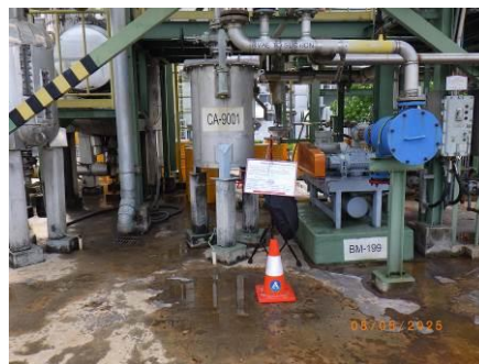
บริเวณไอระเหยขาออกจาก Carbon Absorber
